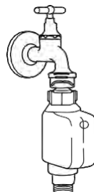
Mangueira de abastecimento de segurança
