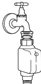
Mangueira de abastecimento de segurança
