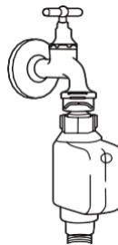
Mangueira de abastecimento de segurança
